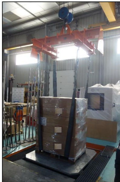
Fotografía 19. Colocación de la carga paletizada en la mesa de vibración
