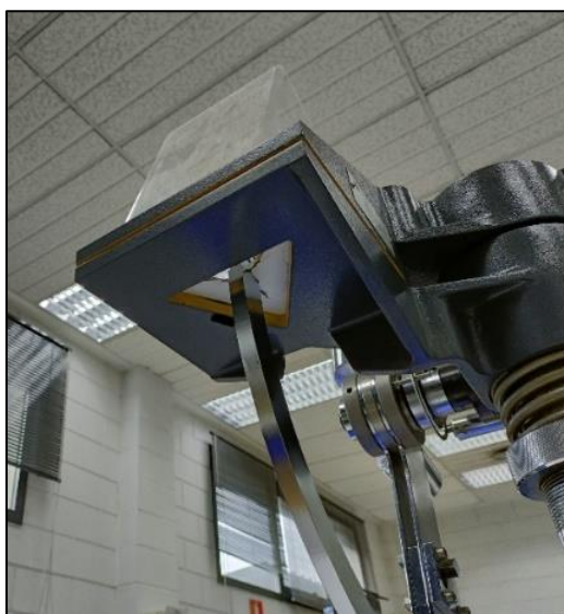
Fotografía 12. Evaluación de la resistencia a la perforación
