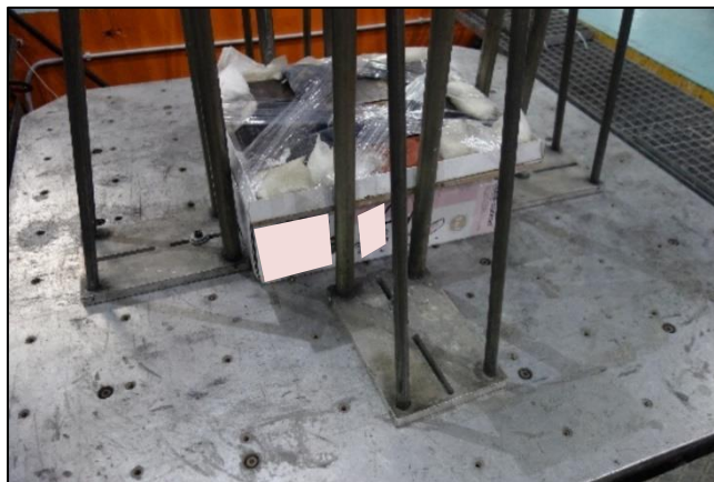
Fotografía 15. Vibración con peso. Embalaje unitario sobre cara 3
