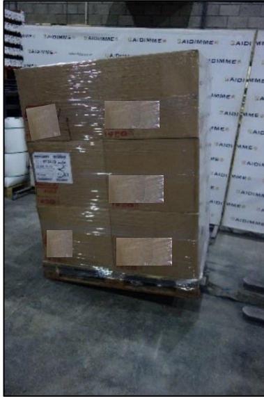
Fotografía 20. Carga paletizada. Caída rotacional sobre cara 5
