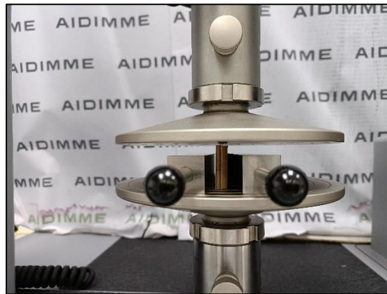
Fotografía 11. Determinación de la resistencia al aplastamiento sobre el canto (ECT)
